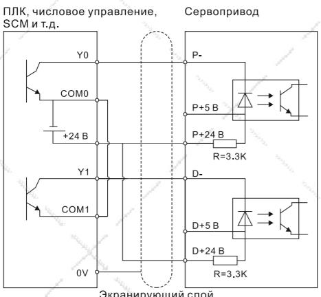
Когда верхнее устройство использует выход с открытым коллектором, используется этот метод подключения. Обратите внимание, что P+ 5V и D+ 5V приостановлены.
