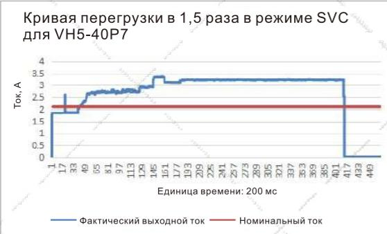
Время перегрузки преобразователя частоты VH5 в 1,5 раза:
