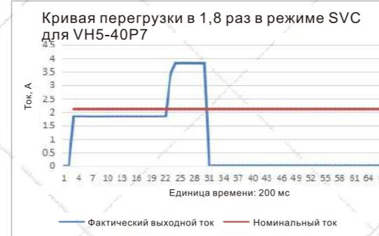
Время перегрузки преобразователя частоты VH5 в 1,8 раза:
