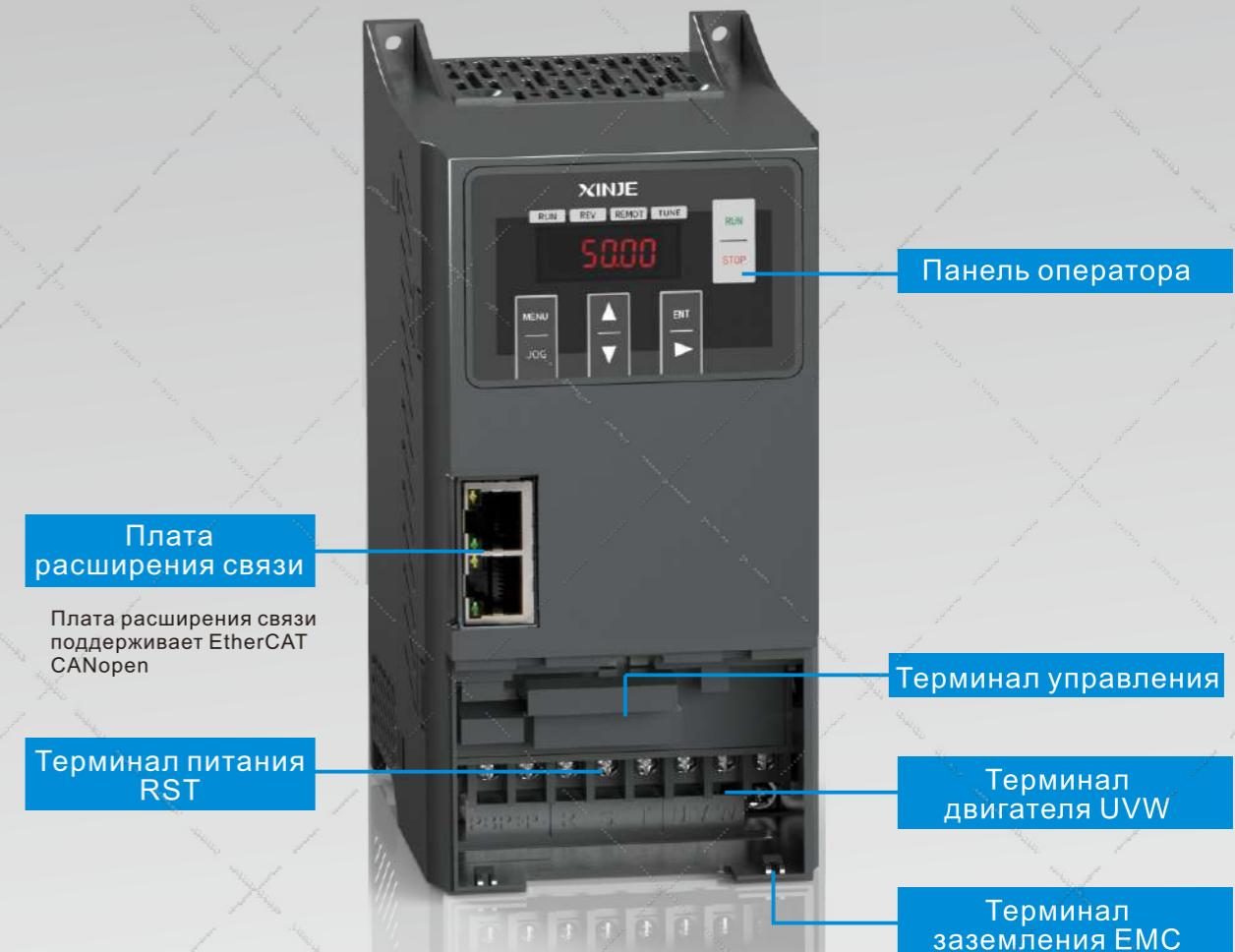
Преобразователь частоты VH5 стандартно оснащен одним коммуникационным портом RS485. Кроме того, его можно подключить к сетям EtherCAT и CANopen через специальную плату расширения связи в качестве ведомой станции.
