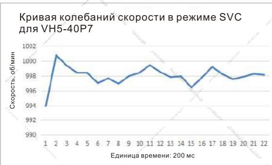
Флуктуация скорости преобразователя частоты VH5: ±0.3%
