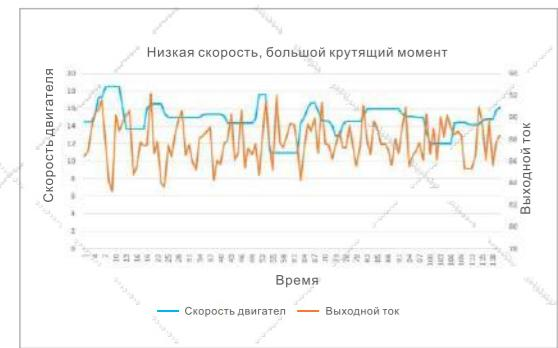
Когда преобразователь частоты серии V6 приводит двигатель в действие с частотой 0,5 Гц, выходной крутящий момент достигает 180%, что отражает высокие характеристики крутящего момента на низких частотах.
