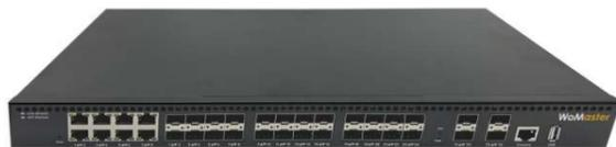
ОПИСАНИЕ: Управляемый коммутатор уровня L2+ 8 x Giga Combo портов, 4x1G/10G SFP и 16 x 100/1000M SFP, IEC61850, PTPv2, 100 ~ 240 В переменного тока, 50/60 Гц
