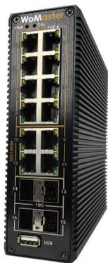
ОПИСАНИЕ : Управляемый коммутатор уровня L2+ с 12 x 10/100/1000BaseT RJ45, автоматическое согласование и 4 x 1G/10G Base SFP, PTPv2, 24 В постоянного тока (12 ~ 52 В постоянного тока)
