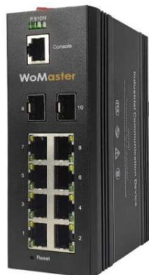
ОПИСАНИЕ : Управляемый коммутатор уровня L2 с 8 x 10/100/1000Base-T RJ45 PoE с автоматическим согласованием, Auto MDI/MDIX и 2x100/1000M SFP, PTPv2, 48 В постоянного тока (48 ~ 57 В постоянного тока)
