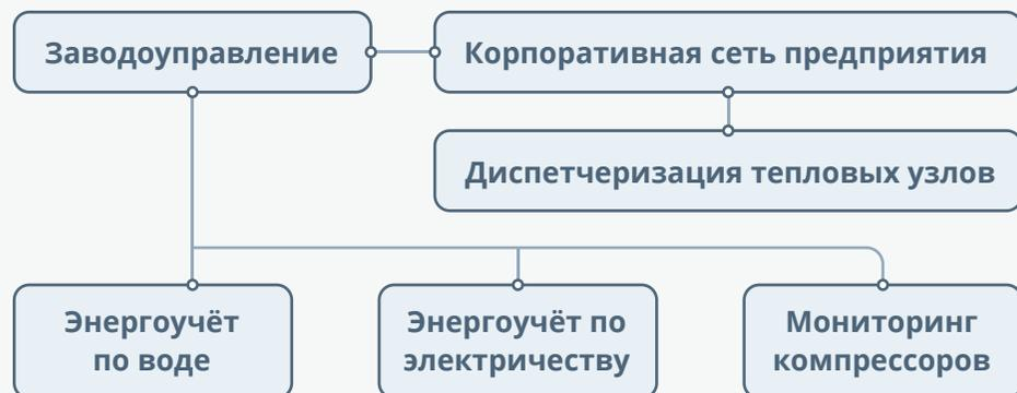
Принципиальная схема требуемой системы диспетчеризации
